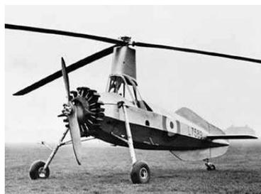
**El Autogiro** El ingeniero Juan de la Cierva inventó y construyó este tipo de aeronave en la década de 1920. El invento consiste en el fuselaje de un avión convencional, que dispone de una hélice frontal y un motor, y por encima del conjunto un rotor libre, que gira con la presión del aire generada durante el impulso horizontal del aparato, creando sustentación vertical.
