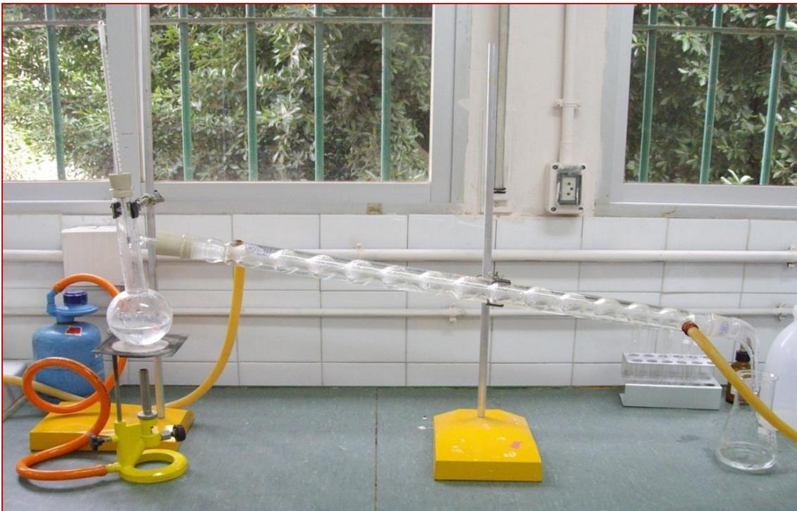
En este equipo de destilación se puede observar, además del matraz de destilación y otros elementos, un condensador o refrigerador, que sirve para condensar un vapor haciendo circular agua fría en contracorriente a través del mismo. Los hay de diversos tipos: recto, de bulbos y de serpiente.
