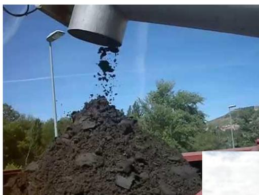
Si finalmente se aplica un **secado térmico**, pueden conseguirse lodos con un 70%-90% de sólido seco. El lodo se desinfecta y posteriormente se valoriza energéticamente (se usa como combustible) o se utiliza como fertilizante en la agricultura.
